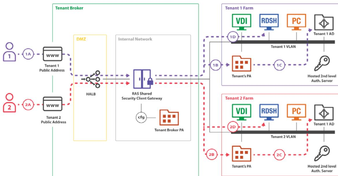
テナントブローカーにインストールされている共有の RAS Secure Client Gateway は、複数のテナントファームで複数のユーザーセッションを同時に処理できます。上の図では、2 人のユーザー (1 と 2) が別々のテナントファーム (テナント 1 ファームとテナント 2 ファーム) に接続しています。どちらの接続も同じゲートウェイでトンネリングされていますが、それぞれが正しいテナントファームに送られています。
